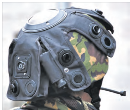
Лазерный имитатор стрельбы из стрелкового оружия
